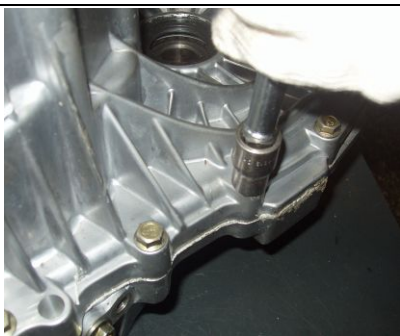
3.3.6 装倒档齿轮轴螺栓
