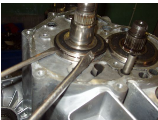
拆输入轴左轴承卡圈
