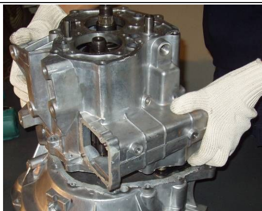
3. 1. 12 拆倒档换挡拨叉螺栓
