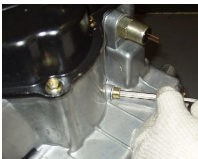
3.3.7 装配变速器自锁机构
