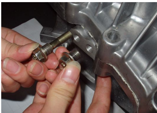
3.3.9 装五倒档互锁螺栓和换档限位螺栓
