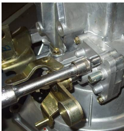
3.3.9 装五倒档互锁螺栓和换档限位螺栓
