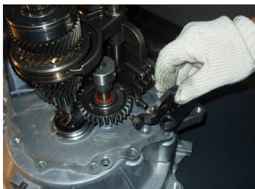
取下倒档齿轮轴和倒档齿轮
